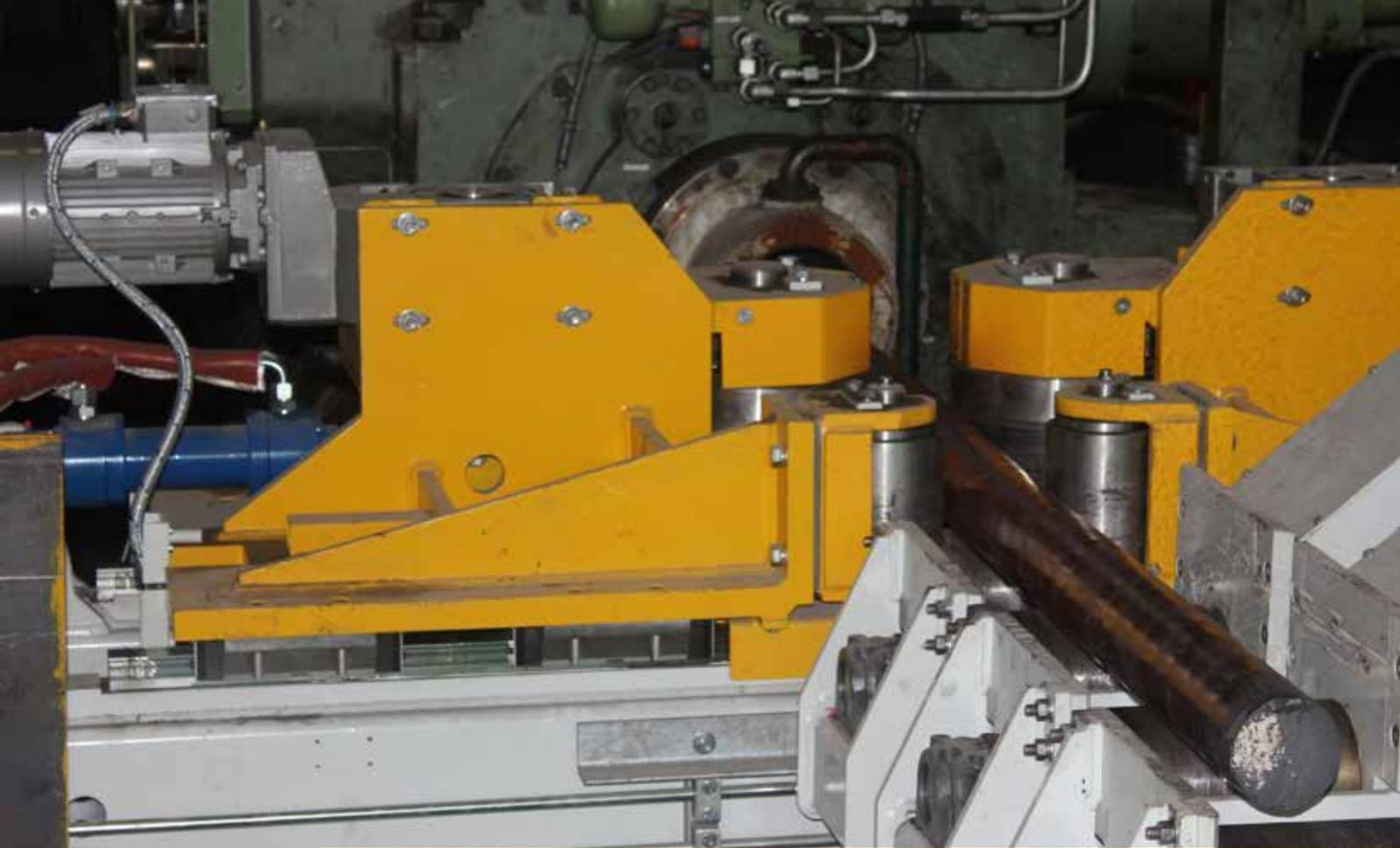
Zwei Watt-Getriebemotoren sorgen dafür, dass die größeren Schmiedestücke von der Materialdurchzieheinheit vollautomatisch aus dem Schmiedemanipulator auf dem heb- und senkbaren Rollgang abgelegt werden.
