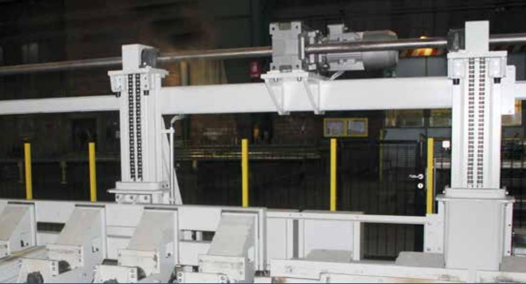
Der heb- und senkbare Rollgang befördert die verschiedenen getrennten Schmiedestücke vom Schmiedemanipulator auf die höhere Rollgangslinie der Trennschleifmaschine.
