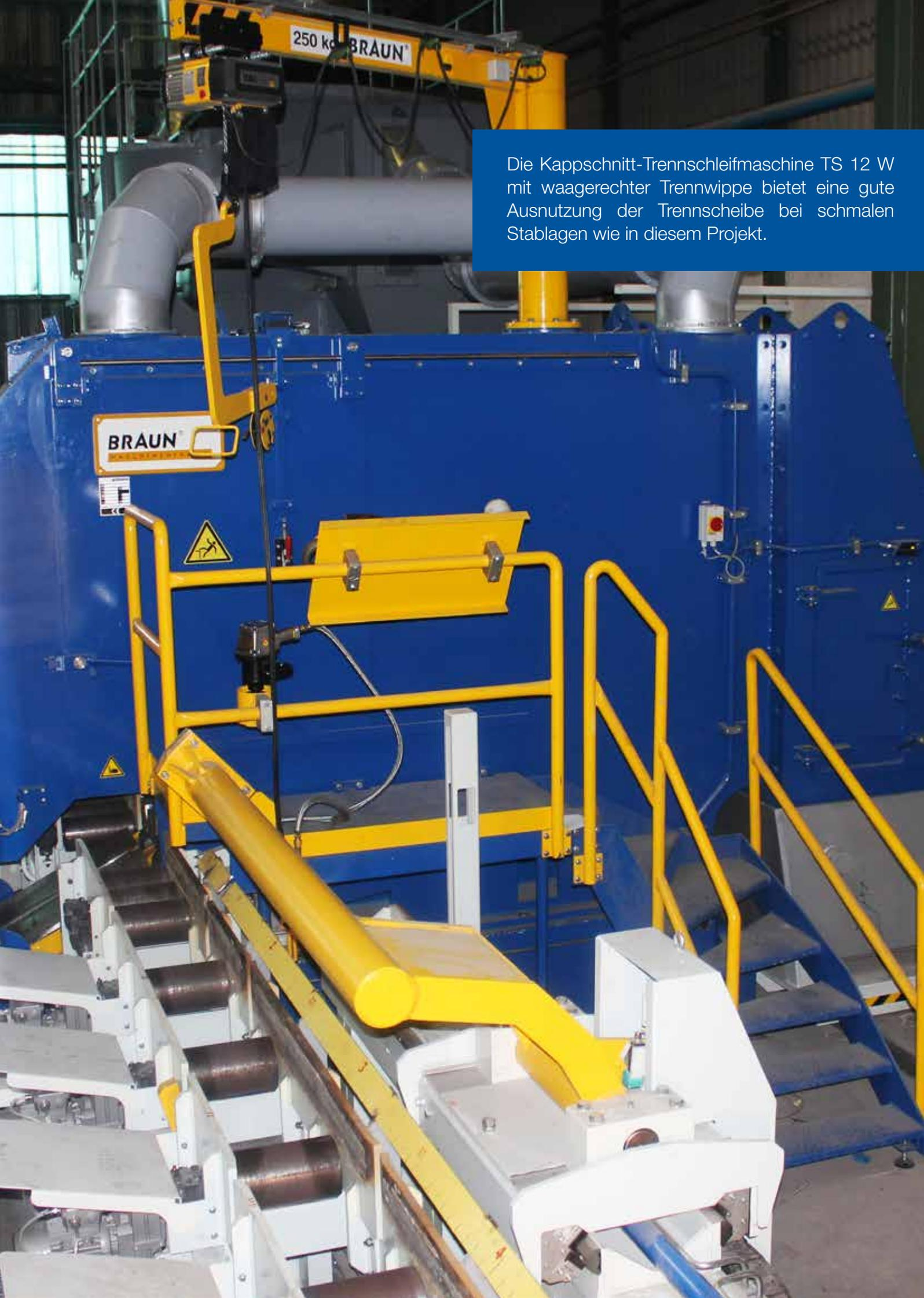
Die Kappschnitt-Trennschleifmaschine TS 12 W mit waagerechter Trennwippe bietet eine gute Ausnutzung der Trennscheibe bei schmalen Stablagen wie in diesem Projekt.
