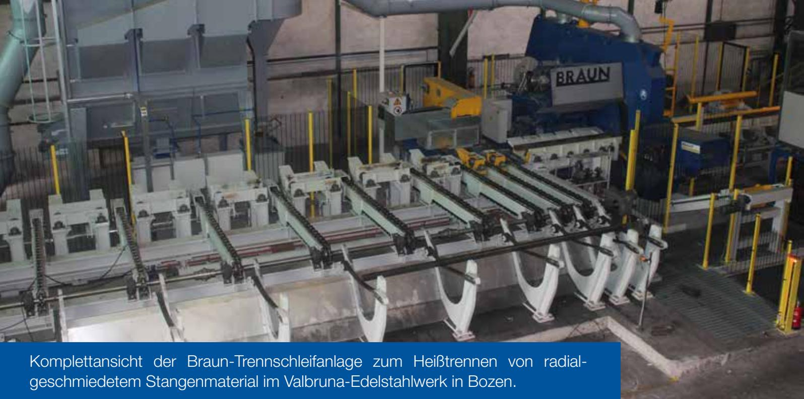
Komplettansicht der Braun-Trennschleifanlage zum Heißtrennen von radial-geschmiedetem Stangenmaterial im Valbruna-Edelstahlwerk in Bozen.
